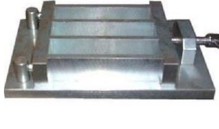
Şekil 2. 40 x 40 x 160 mm kalıp
